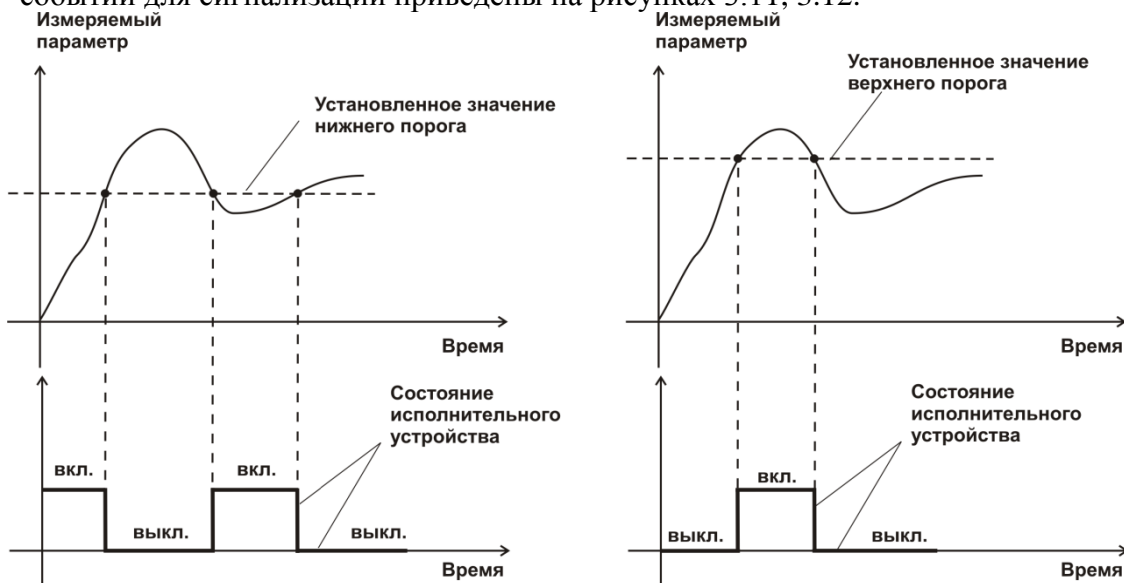
Рисунок 3.11 События: нарушения НП (слева), нарушение ВП (справа)
